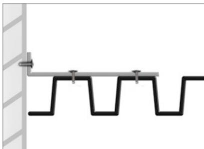
— В местах примыканий кровли к вертикальным конструкциям (парапеты, стены, вентиляционные шахты, выходы на кровлю и т.п.) установите и закрепите L-образный элемент из оцинкованной стали. Толщина используемой стали должна быть не менее 0,8 мм.
