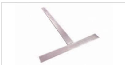
— Т-образный кровельный костыль — предназначен для крепления оцинкованных отливов и фартуков на парапеты. Костыль должен быть толщиной не менее 4 мм и покрыт антикоррозионными составами.
