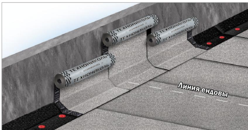
Расстояние между боковыми стыками кровельных полотенц в смежных слоях на парапете должно быть 300–600 мм.
