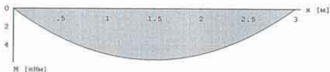
Рис. 18. Эпюра изгибающего момента
